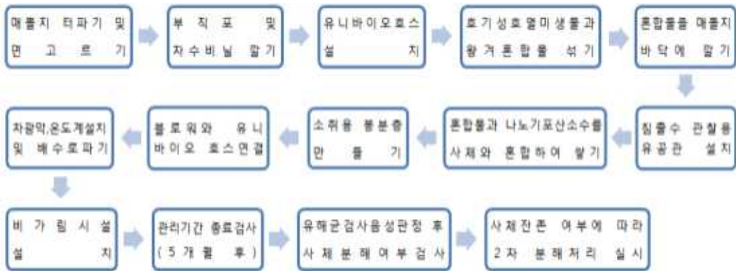
[그림 1] 호기성호열미생물을 이용한 가축사체 처리 절차도
